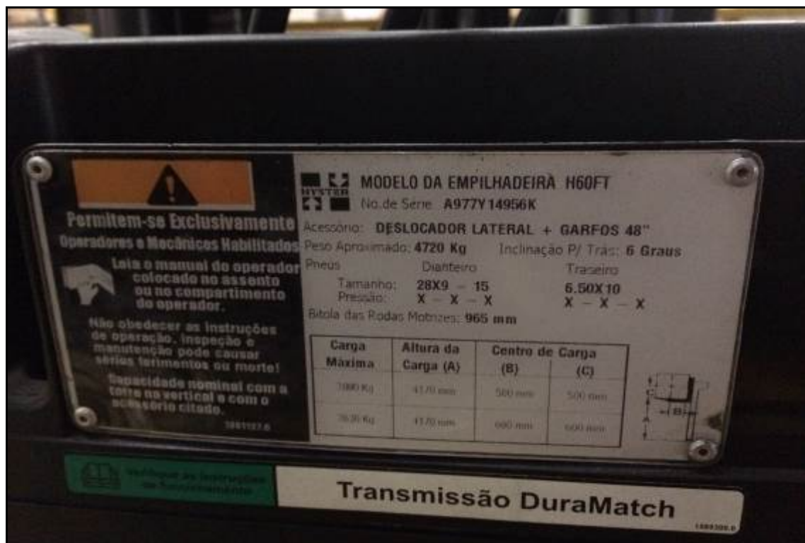
ITEM 1,009 - VISTA DA PLACA DE IDENTIFICAÇÃO DA EMPILHADEIRA GLP MARCA: HYSTER MODELO: H60FT SÉRIE: A977Y14956K
