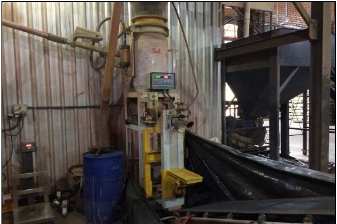
ITEM 1,002 - VISTA DA ENSACADEIRA PNEUMATICA MARCA: SAT PARANA MODELO: ES 4001 SB CAP: 40KG SÉRIE: 109
