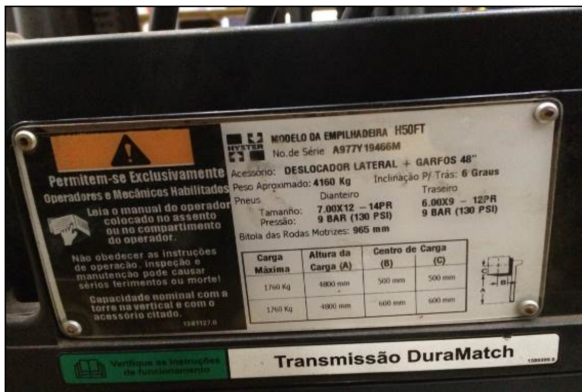
ITEM 1,008 - VISTA DA PLACA DE IDENTIFICAÇÃO DA EMPILHADERA GLP MARCA: HYSTER MODELO: H50FT SÉRIE: A977Y19466M
