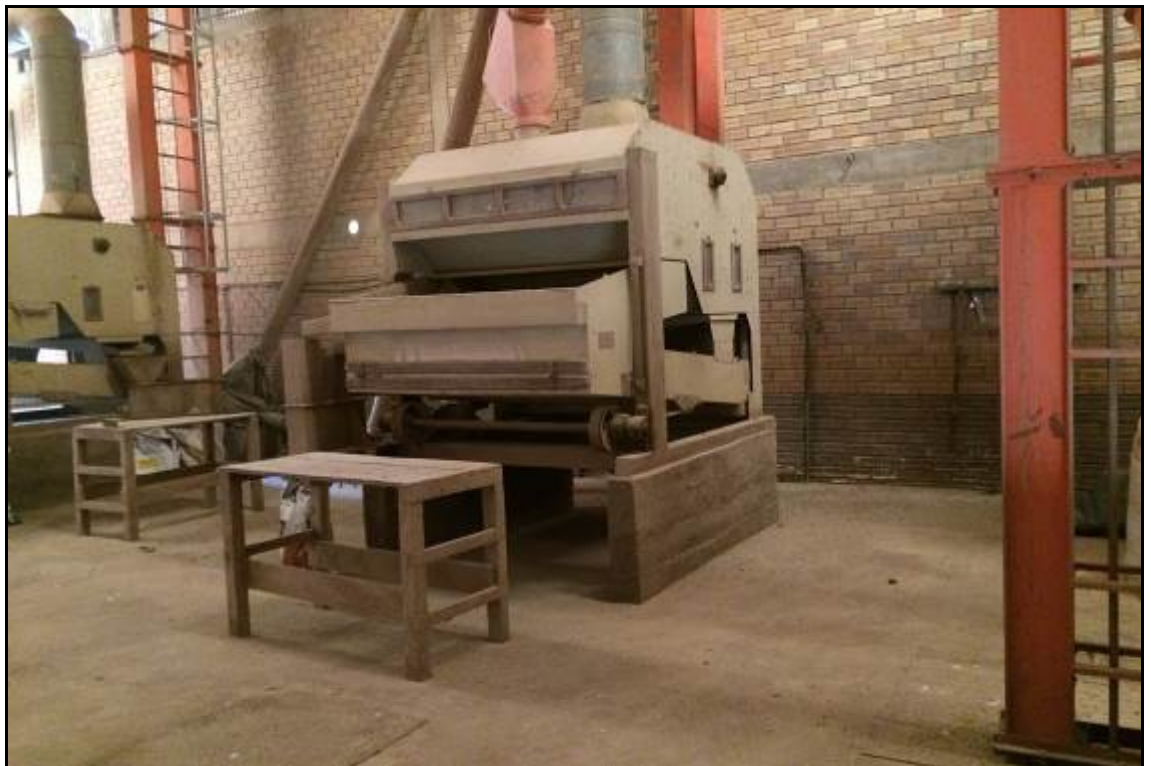
ITEM 2,007 - VISTA DA MÁQUINA DE LIMPEZA MARCA: KEPLER WEBER MODELO: LC 160 SÉRIE: 36/09
