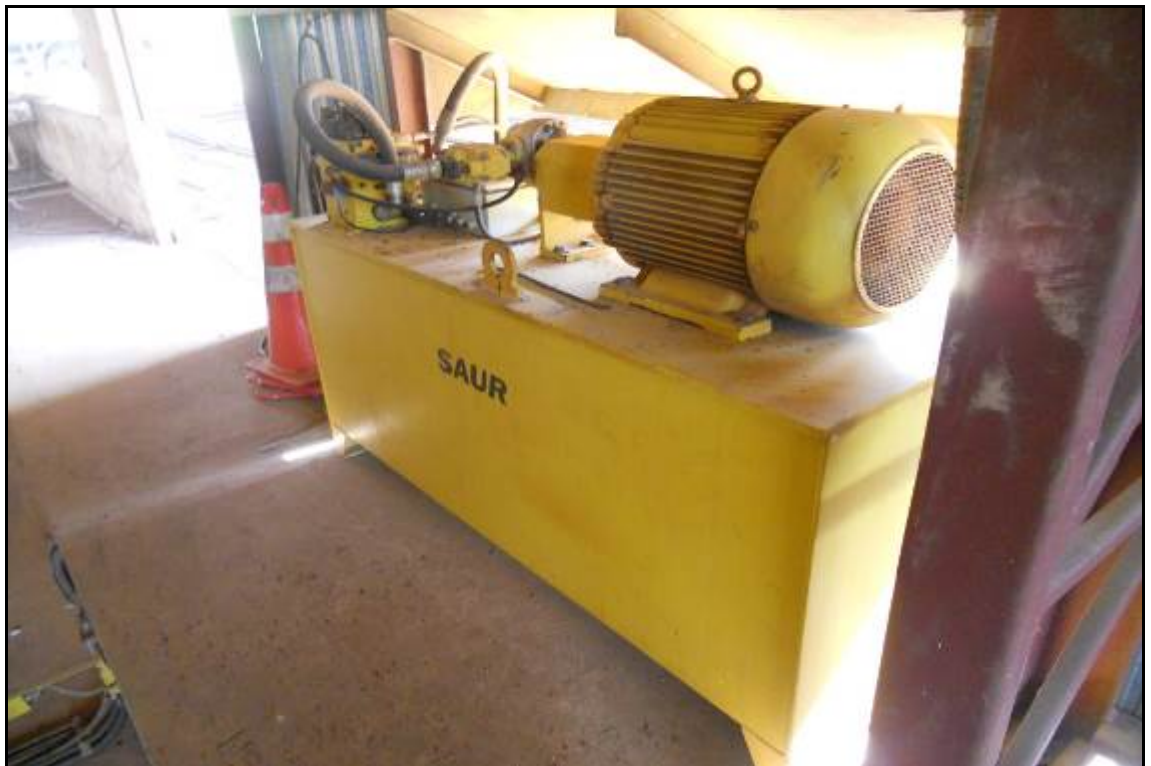
ITEM 1,006 - VISTA DO TOMBADOR DE VEÍCULOS MARCA: SAUR PARA BI-TREM COM UNIDADE HIDRÁULICA
