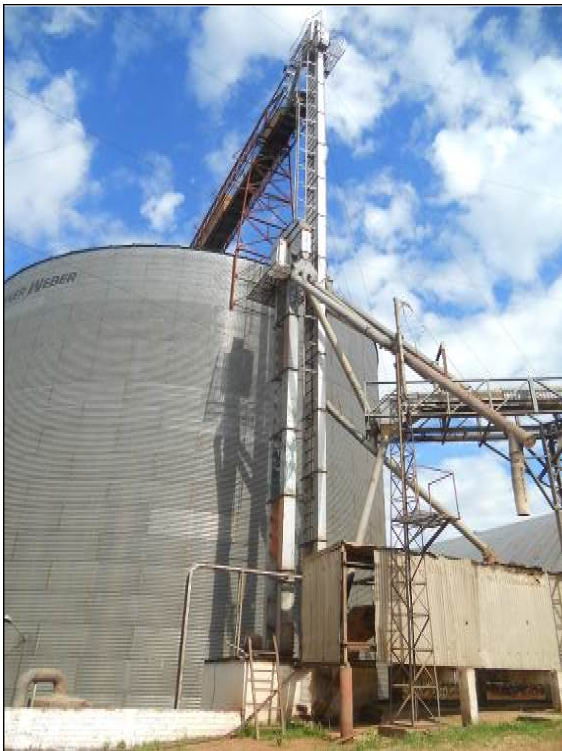
ITEM 1,031 - VISTA DO ELEVADOR DE CANECAS PLÁSTICA PARA CAPTAÇÃO DE GRÃOS DA CORREIA TRANSPORTADORA INFEIOR PARA A CORREIA TRANSPORTADORA SUPERIOR DOS SILOS
