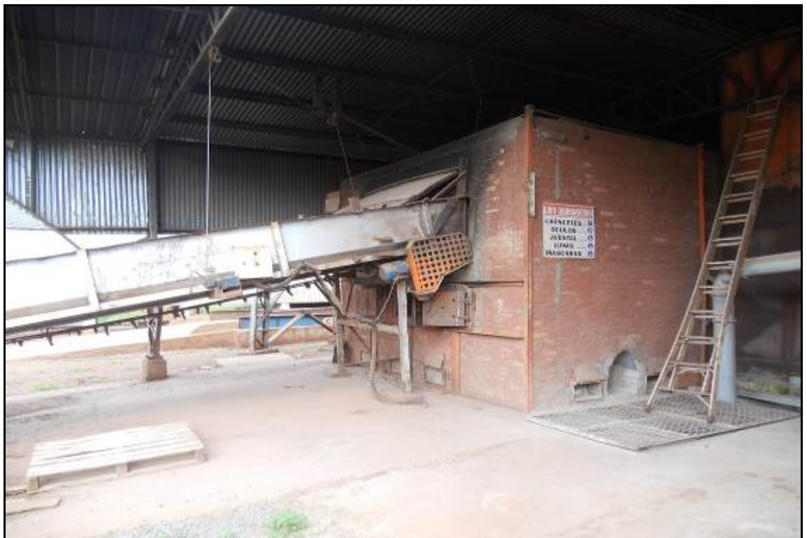
ITEM 1,018 - VISTA DA FORNALHA A LENHA DO SECADOR DE COLUNA COMPOSTA POR: TIJOLOS REFRAATÁRIOS, ESTRUTURA METÁLICA, E SISTEMA DE CONTROLE DE TEMPERATURA
