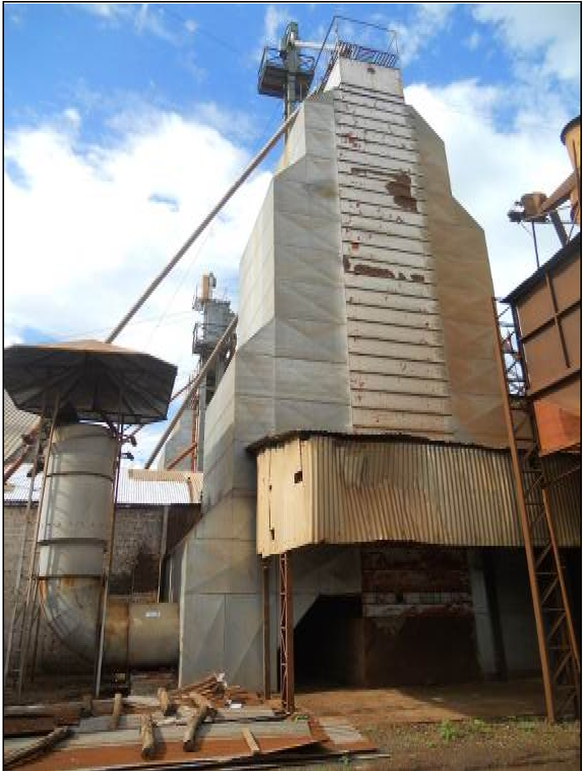
ITEM 1,019 - VISTA DO SECADOR DE COLUNA PARA GRÃOS CAP: 40 TON
