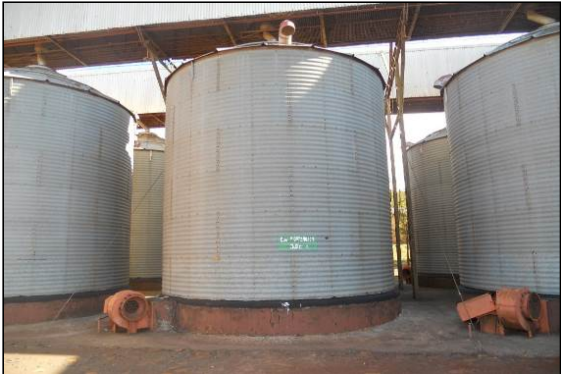
ITEM 2,013 - VISTA DO SILO DE ARMAZEMAGEM METÁLICO CAP: 90 TON COM VENTILADOR CENTRÍFUGO Nº 31
