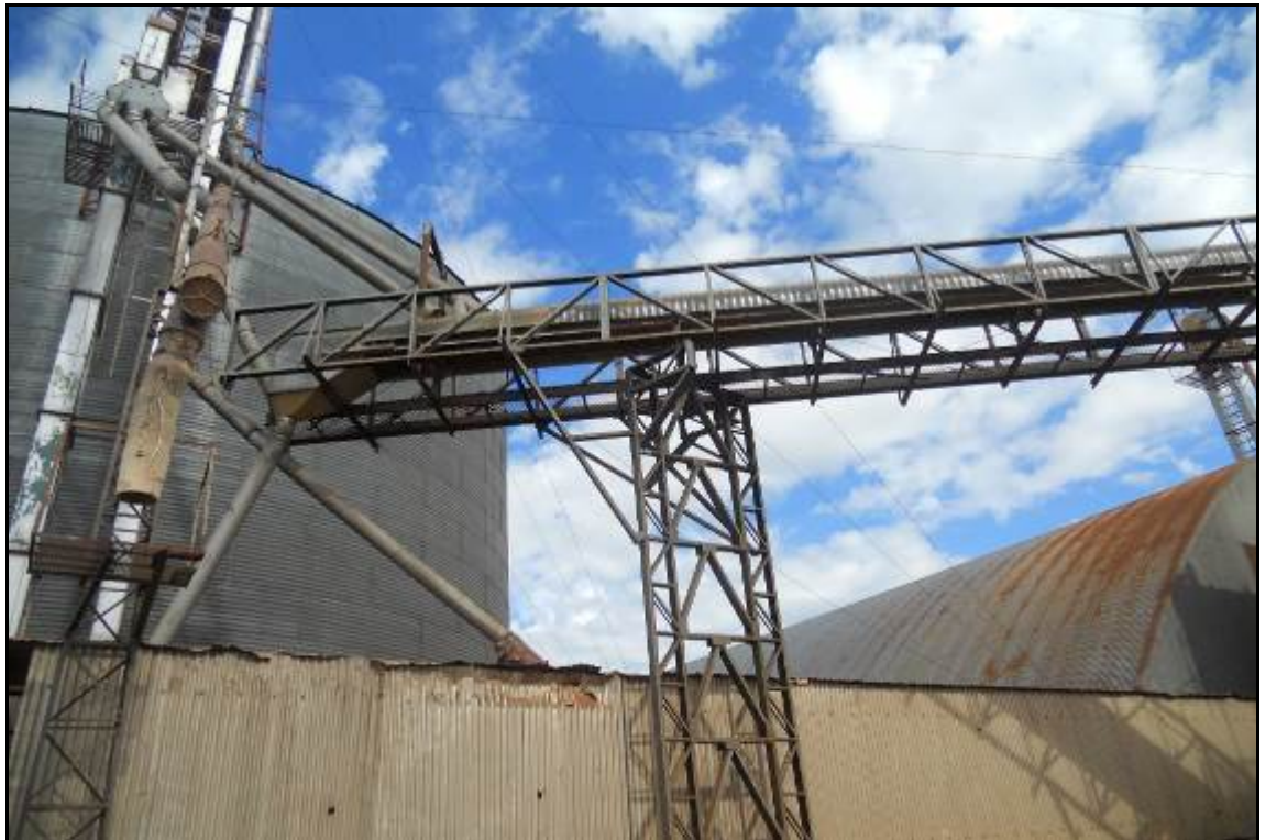
ITEM 1,030 - VISTA DA CORREIA TRANSPORTADORA INFERIOR PARA CAPTAÇÃO DE GRÃOS DO ELEVADOR DE CANECAS DO SECADOR PARA O ELEVADOR DE CANECAS DOS SILOS
