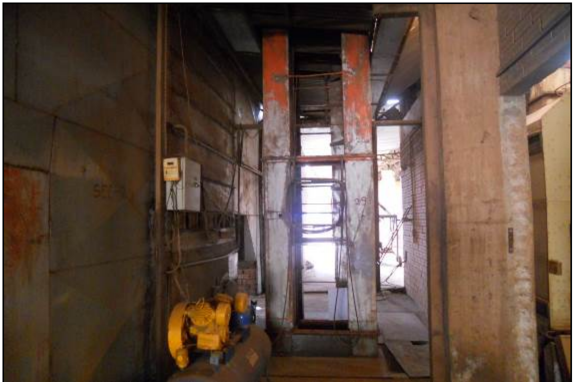
ITEM 1,022 - VISTA DO ELEVADOR DE CANECAS PLÁSTICA PARA CAPTAÇÃO DE GRÃOS DO SECADOR PARA TULHA DE EXPEDIÇÃO DE RESÍDUOS E SILO DE EXPEDIÇÃO
