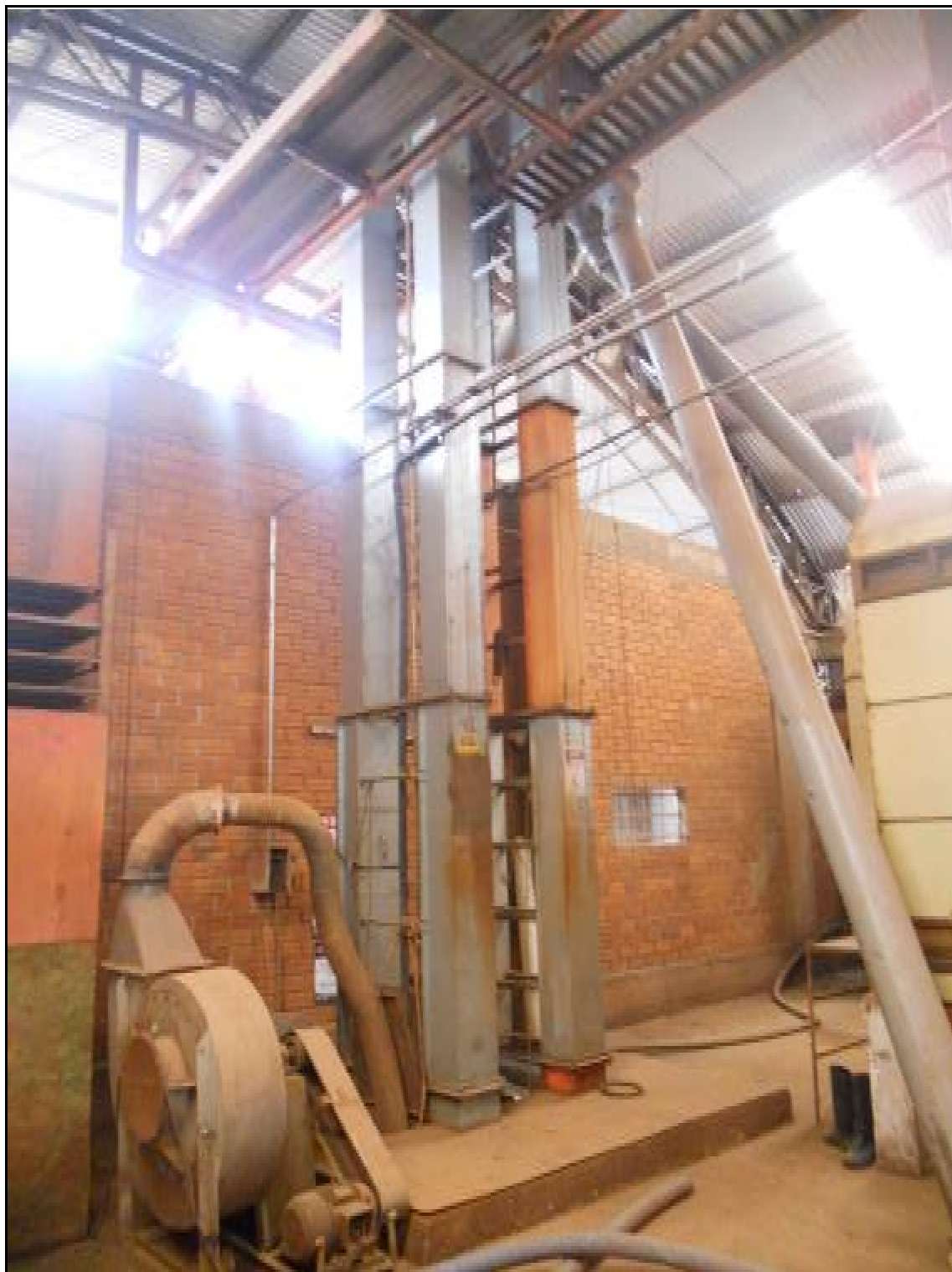
ITEM 1,007 / ITEM 1,008 - VISTA DO ELEVADOR DE CANECAS PLÁSTICA PARA CAPTAÇÃO DE GRÃOS DA MOEGA PARA A MÁQUINA DE PRÉ-LIMPEZA
