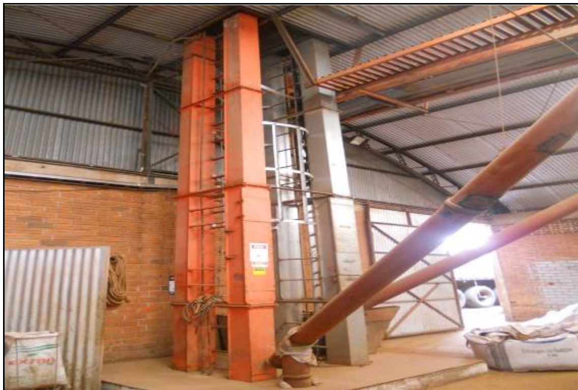
ITEM 1,016 - VISTA DO ELEVADOR DE CANECAS PLÁSTICA PARA CAPTAÇÃO DE GRÃOS DA MÁQUINA DE PRE LIMPEZA PARA O SECADOR CAP: 40 TON
