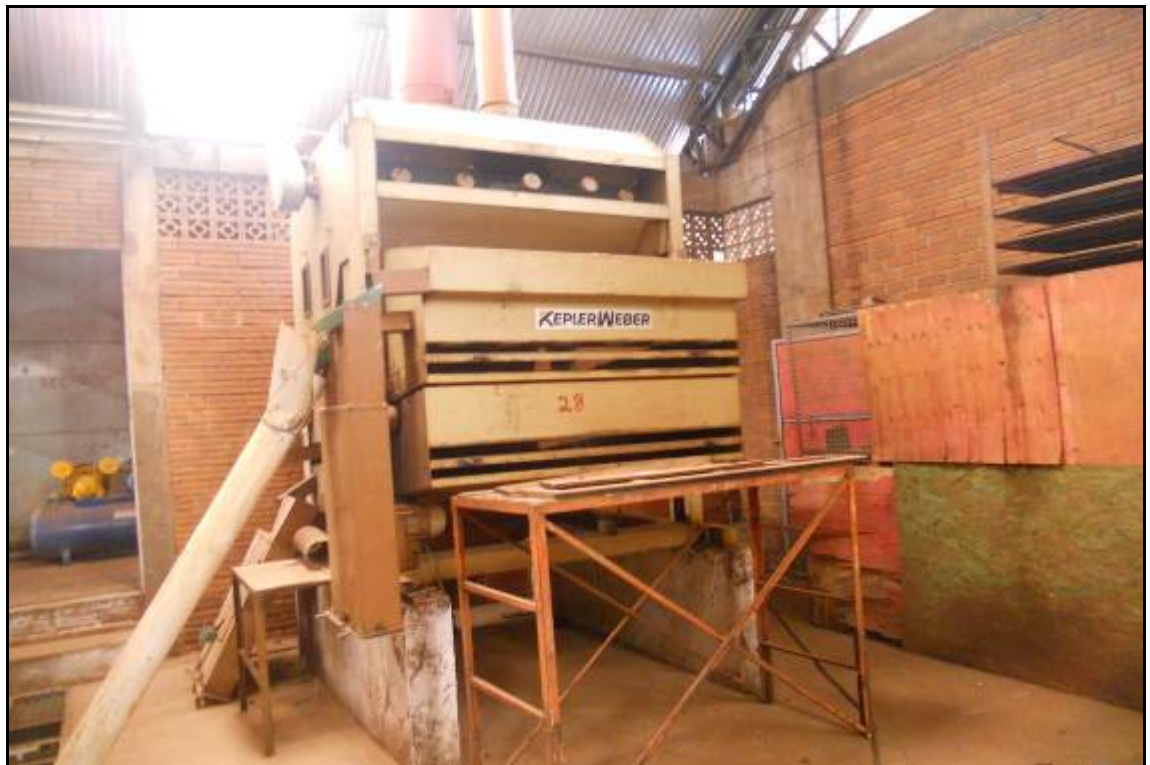
ITEM 1,011 - VISTA DA MÁQUINA DE LIMPEZA MARCA: KEPLER WEBER MODELO: SP 160
