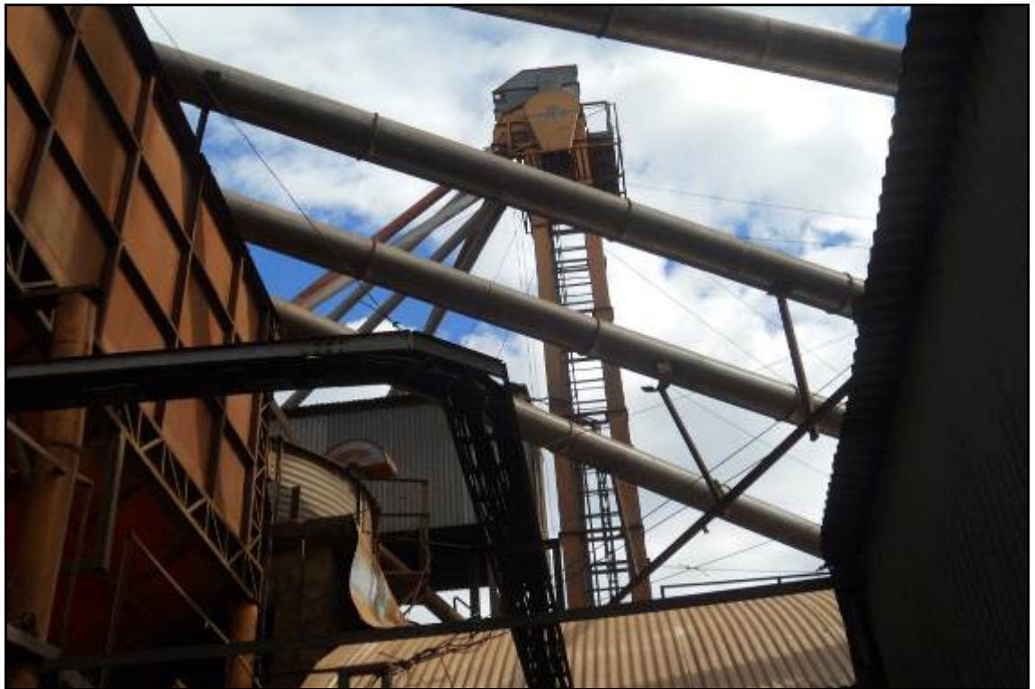
ITEM 1,015 - VISTA DO ELEVADOR DE CANECAS PLÁSTICA PARA CAPTAÇÃO DE GRÃOS DA MÁQUINA DE PRE LIMPEZA PARA O SECADOR CAP: 60 TON
