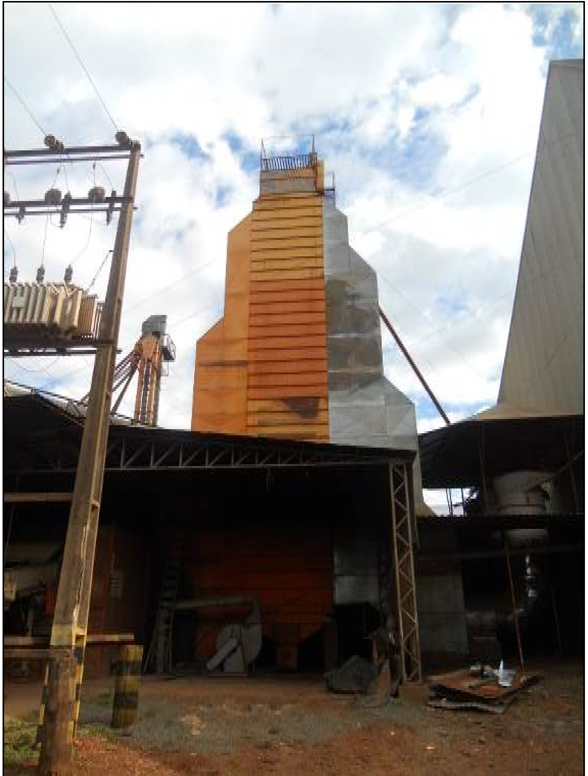
ITEM 1,017 - VISTA DO SECADOR DE COLUNA PARA GRÃOS CAP: 60 TON
